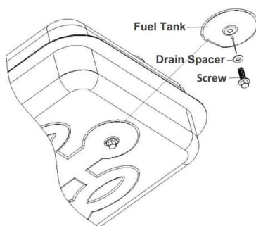
Bild 6 Borttagning av avtappningsplugg. Justering av pumptryck
